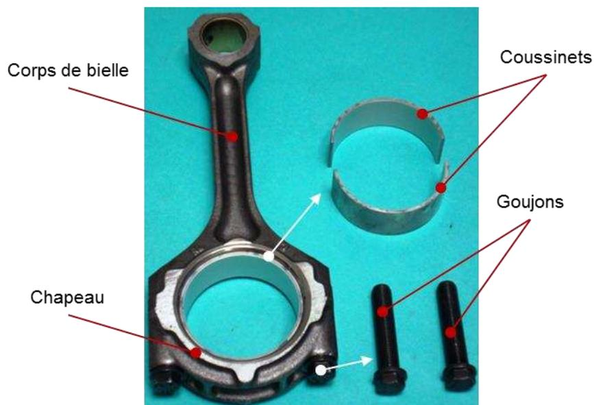
Figure 1. Bielle des moteurs d'automobile avec coussinets sans ergot
