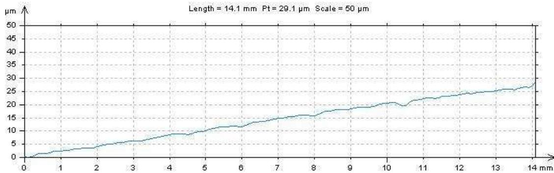
Fig. IV.22. Etendue (*Et*) et profondeur (*Pr*) du dépinçage
